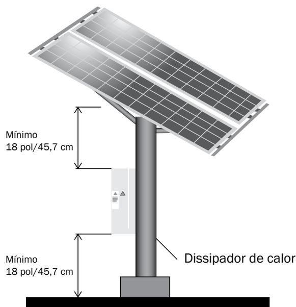
Figura 2: Instalação da unidade de controle
