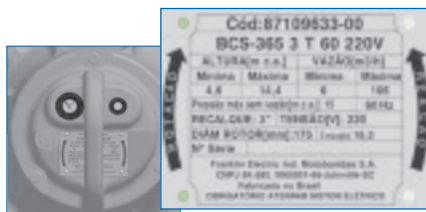
Figura 10 - Plaqueta de identificação da motobomba e sentido de rotação e reação.
