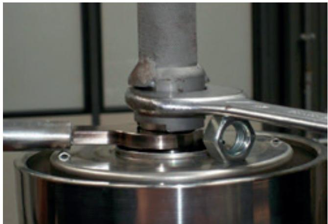
27. Coloque um calço de 40 mm sob a chave de boca 32 mm segurando o gabarito de posicionamento do selo mecânico. Levante o kit hidráulico e aperte a porca do assento do selo mecânico. Torque de aperto: 50 Nm.
