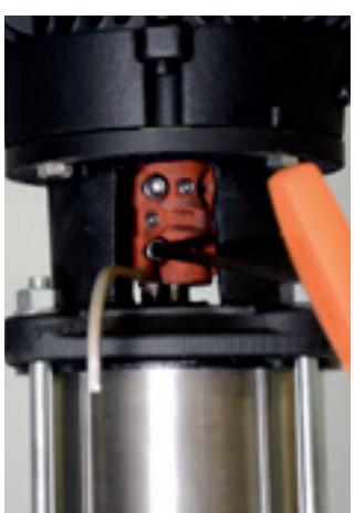
40. Com o auxílio de uma chave hexagonal 6 mm, aperte os parafusos de fechamento do acoplamento.
