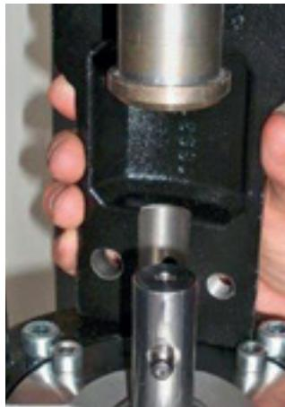
12. Insira o pino no eixo do bombeador, encaixe o acoplamento no pino e levante o kit hidráulico para encaixar o acoplamento no semi-eixo.
