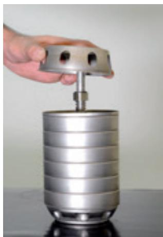
22. Para iniciar a desmontagem do kit hidráulico, retire a tampa de saída.
