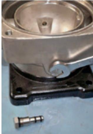
4. Posicione os bujões na base com flange e aperte-os com o auxílio de uma chave combinada 24 mm. Torque de aperto: 40 Nm.
