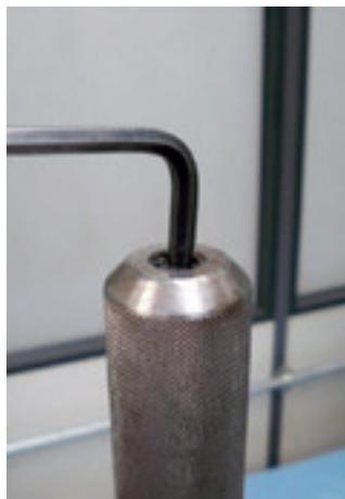
24. Com o auxílio de uma chave hexagonal 5 mm, aperte o parafuso do gabarito. Torque de aperto: 20 Nm.
