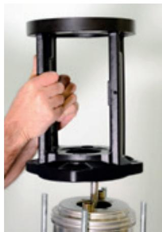
15. Com o auxílio de um martelo de plastiprene bata levemente de baixo para cima e retire o intermediário.
