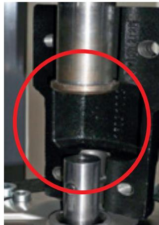
13. Detalhe do posicionamento correto do acoplamento bipartido em relação ao pino e semi-eixo.
