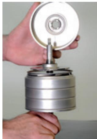
11. Coloque o difusor mancal. Repita os procedimentos até completar o kit hidráulico.
