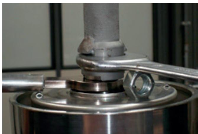
27. Coloque um calço de 40 mm sob a chave de boca 32 mm segurando o gabinete de posicionamento do selo mecânico. Levante o kit hidráulico e aperte a porca do assento do selo mecânico. Torque de aperto: 50 Nm.
