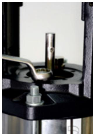
13. Com o auxílio de uma chave combinada 22 mm, retire os bujões superiores.
