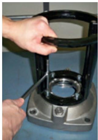
24. Com o auxílio de uma chave hexagonal 8 mm, solte os parafusos de fixação e retire o intermediário da tampa do intermediário.
