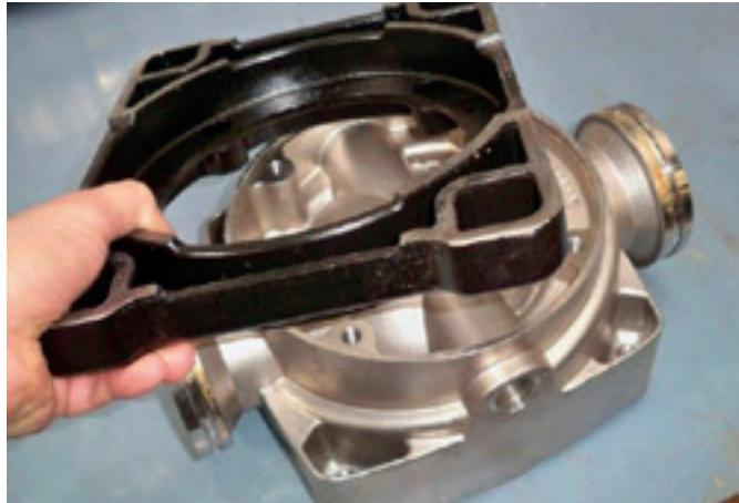
1. Com a base com flange virada, posicione a base da motobomba sobre a mesma.
