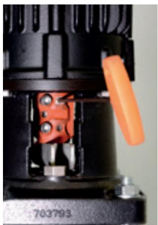
47. Com o auxílio de uma chave hexagonal 4 mm, aperte levemente o parafuso de fixação do eixo do motor.
