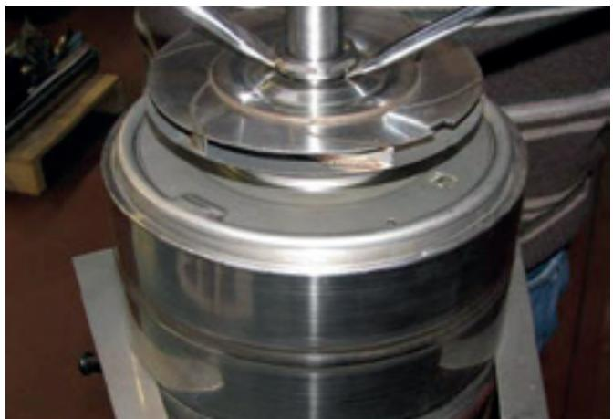
18. Com o auxílio de duas chaves de fenda, levante a contraporca do rotor. Atenção ao correto posicionamento da chave para não danificar o rotor nessa operação.
