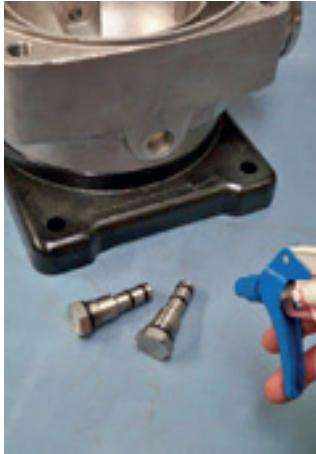
3. Coloque o anel o-ring nos bujões inferiores e lubrifique-os com álcool.
