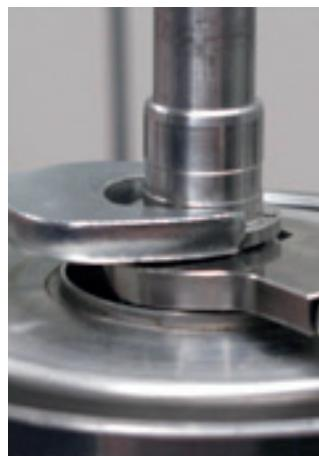
9. Com o auxílio de duas chaves de boca solte as porcas do kit de apoio do selo mecânico.
