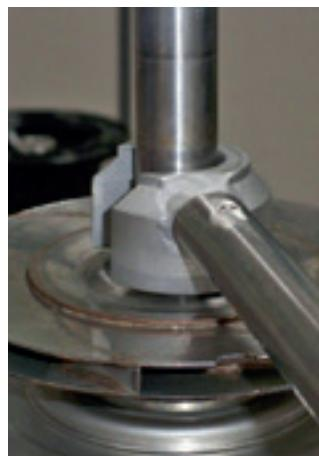
13. Com o auxílio do gabarito para rotor, solte a porca do rotor.
