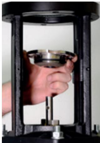
39. Coloque a tampa do selo mecânico. Para facilitar o encaixe, utilize álcool.
