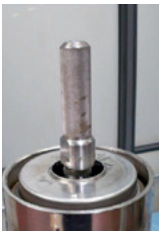
21. Coloque o gabarito de posicionamento do selo mecânico no assento do selo mecânico.
