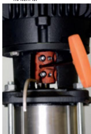
39. Com auxílio de uma chave hexagonal 4 mm, solte o parafuso de abertura do acoplamento.
