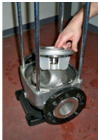
23. Retire o kit tampa de entrada da base com flange da bomba.
