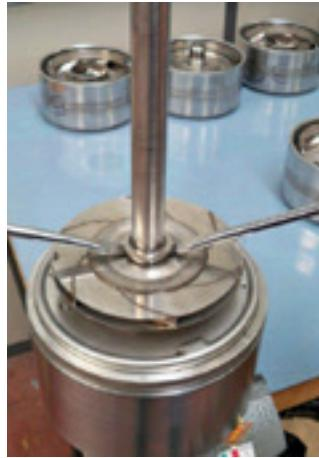
8. Com o auxílio de duas chaves de fenda, levante a contraporca do rotor. Atenção ao correto posicionamento da chave para não danificar o rotor nessa operação.
