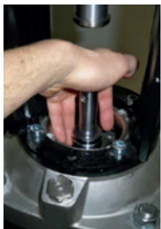
12. O selo mecânico está facilmente acessível para retirada. Para facilitar, lubrifique o eixo com álcool.
