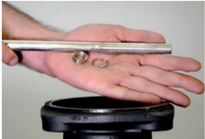
38. Para finalizar a desmontagem, retire o eixo, o anel bipartido e a bucha eixo.
