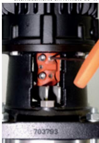
50. Com o auxílio de uma chave hexagonal 4 mm, solte os parafusos de fixação do eixo do bombeador e do eixo do motor.
