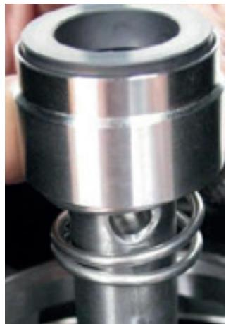
1. Coloque o selo mecânico no eixo do bombeador. Para facilitar a montagem lubrifique o eixo com álcool.
