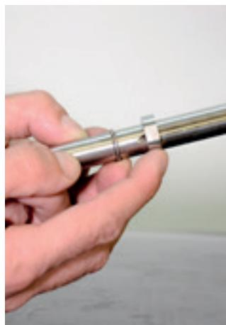
1. Inicie a montagem pelo kit hidráulico, posicionando o anel bipartido e a bucha no eixo.
