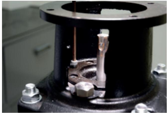
10. Utilize dois parafusos como extratores e com auxílio de uma chave hexagonal 5 mm, aperte alternadamente para a retirada da tampa do selo.
