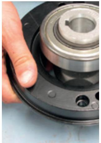
1. Com o auxílio de uma chave hexagonal 6 mm, solte os parafusos do adaptador curto do motor.
