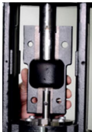
44. Posicione o acoplamento no eixo de modo que o pino fique encaixado no mesmo.
