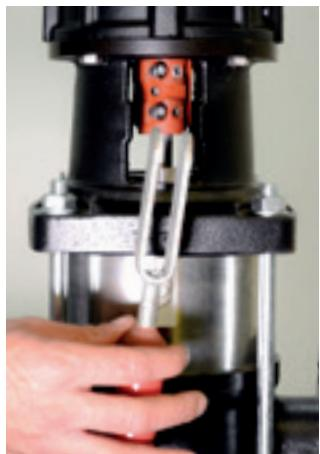
53. Retire o gabarito de ajuste do acoplamento.
