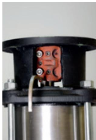
35. Encaixe sob o acoplamento o gabarito de ajuste do acoplamento. A especificação dos gabaritos pode ser identificada no item 15.
