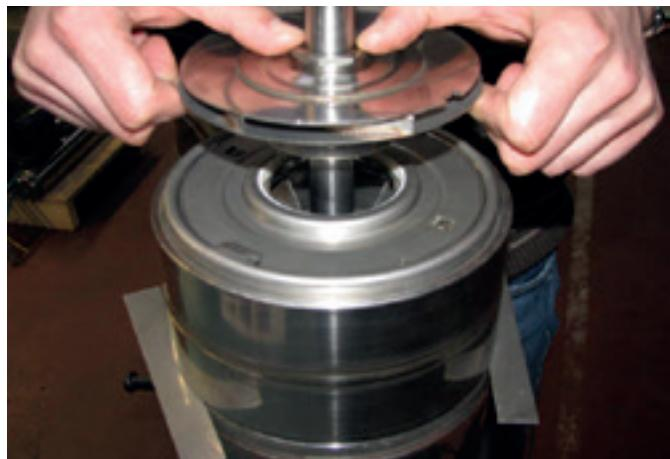
16. Posicione as duas réguas de 1 mm de espessura entre o kit tampa de entrada e o difusor e coloque o rotor.
