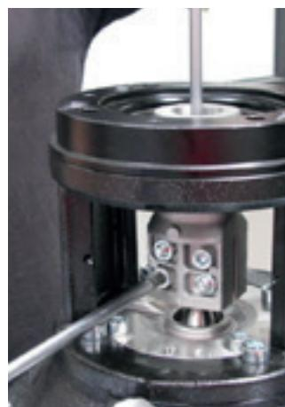
3. Trave o eixo e com o auxílio de uma chave hexagonal 5 mm, solte o parafuso de fixação do acoplamento no eixo.
