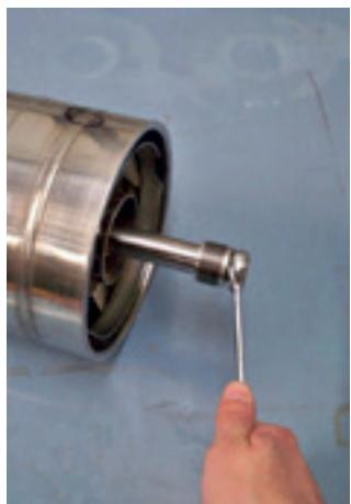
31. Coloque o parafuso e a arruela do kit de fixação do eixo e com o auxílio de uma chave combinada 19 mm, aperte o parafuso. Torque de aperto: 50 Nm.
