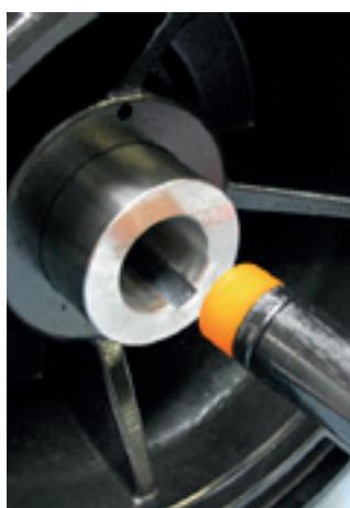
6. Com uma prensa ou com o auxílio de um martelo de plastiprene, retire o semi eixo do adaptador do motor.
