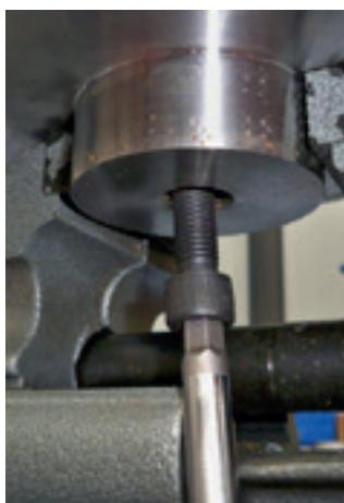
24. Com o auxílio de uma chave hexagonal 10 mm, solte o parafuso do eixo do gabarito base de montagem.
