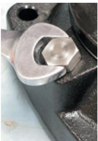
38. Com o auxílio de uma chave combinada 24 mm, coloque e aperte os bujões na tampa do intermediário. Torque de aperto: 40 Nm.
