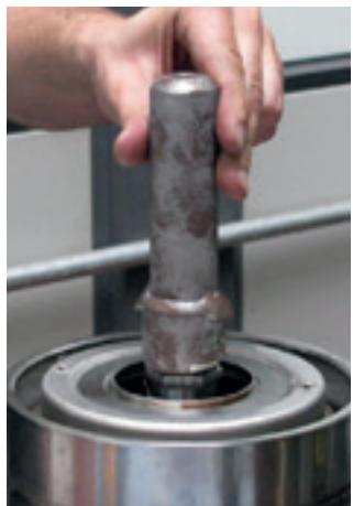
16. Coloque o gabarito de posicionamento do selo mecânico sobre o assento do selo mecânico.
