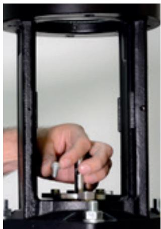
40. Posicione os parafusos da tampa do selo mecânico.
