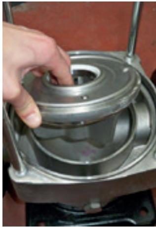
31. Coloque o kit tampa de entrada na base com flange, com as hastes já posicionadas.
