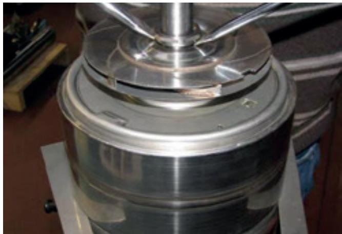
17. Com o auxílio de duas chaves de fenda, levante a contraporca do rotor.
