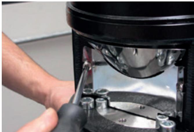
18. Com o auxilio de uma chave Philips, aperte os parafusos de fixação da tampa protetora. Repita a operação no lado oposto do intermediário.
