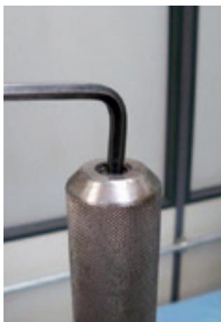
22. Com o auxílio de uma chave hexagonal 5 mm, aperte o parafuso do gabarito. Torque de aperto: 20 Nm.
