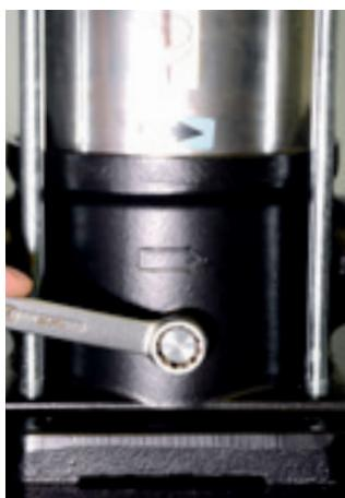
38. Com o auxílio de uma chave combinada 19 mm, aperte o bujão inferior.
