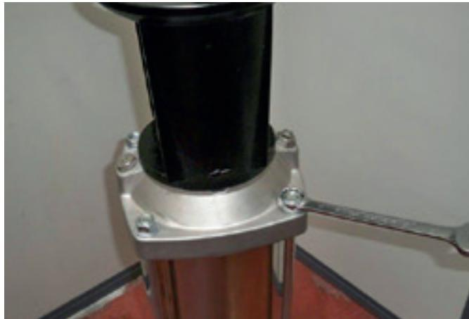
42. Posicione o intermediário juntamente com a tampa do intermediário sobre o kit hidráulico e com o auxílio de uma chave combinada 24 mm, aperte as porcas das hastes. Torque de aperto: 100 Nm.
