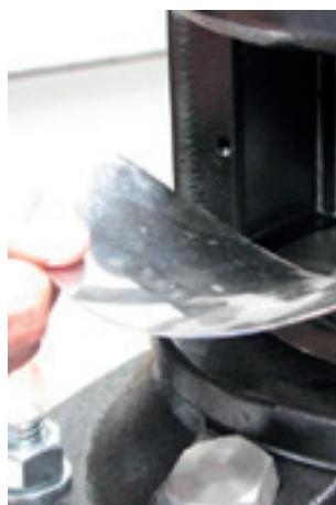
2. Remova a tampa protetora do acoplamento. Repita a operação no lado oposto.
