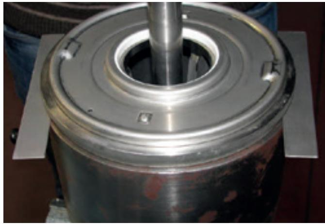
7. Coloque duas réguas 1 mm de espessura cada entre a flange do kit tampa de entrada e o gabarito base de montagem.
