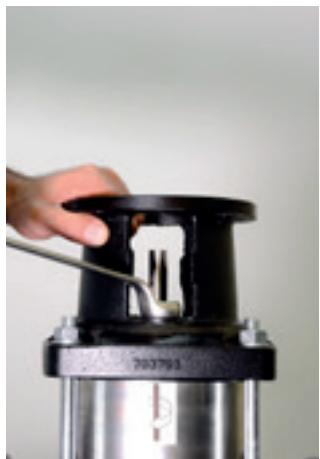
15. Com o auxílio de uma chave combinada 22 mm, retire o bujão superior.
