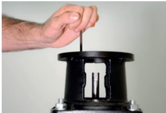
34. Com o auxílio de uma chave hexagonal 5 mm, aperte os parafusos de fixação da tampa do selo mecânico alternadamente em formato de "X".
