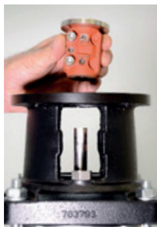
40. Posicione o acoplamento juntamente com o gabarito de ajuste no eixo do bombeador. A especificação dos gabaritos pode ser encontrada no item 15.
