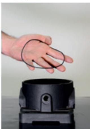
18. Coloque o o-ring de vedação na base da motobomba.
