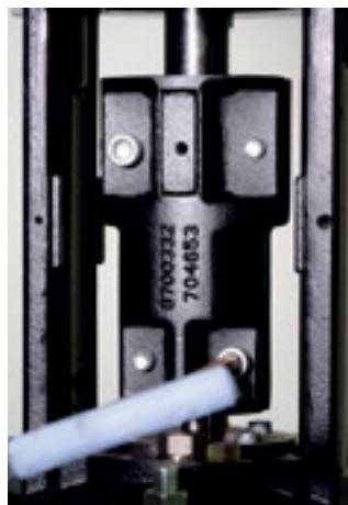
3. Com o auxílio de uma chave hexagonal 10 mm, solte os parafusos do acoplamento.
