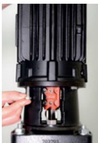
45. Coloque os parafusos de fixação do intermediário no motor.
