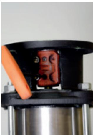
33. Com o auxílio de uma chave hexagonal 4 mm, aperte o parafuso de fixação do eixo do bombeador garantindo que o eixo esteja encostado no gabarito.
