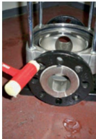
1. Com o auxílio de um martelo de plastiprene, retire o flange deslocando-o para trás.
