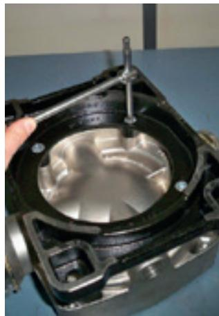
7. Vire a base com flange e retire os parafusos da base da motobomba.
