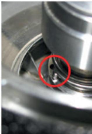
2. Coloque o selo mecânico de forma que o pino da mola encaixe no assento do selo mecânico.
