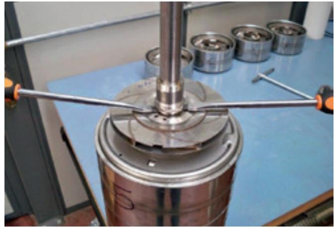
14. Com o auxílio de duas chaves de fenda, levante a contraporca do rotor. Atenção ao correto movimento da chave, a mesma não deve ser utilizada como alavanca. O movimento correto é rotacionar as chaves para levantar a contraporca do rotor.
