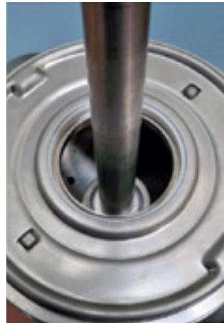
5. Coloque o eixo do bombeador.
