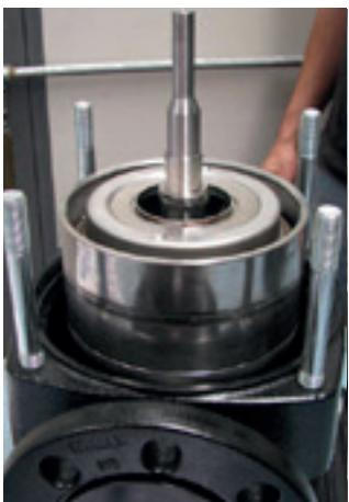
34. Coloque o kit hidráulico na base com flange.
