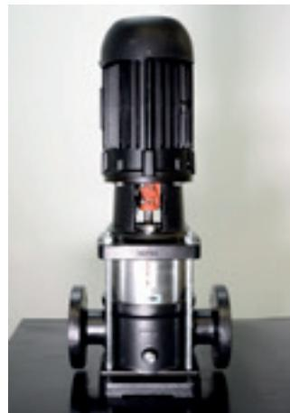
1. Posicione a motobomba sobre uma bancada lisa e firme para iniciar a desmontagem.
