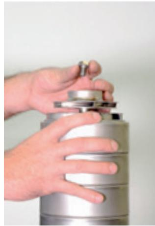
14. Coloque o parafuso de fixação do eixo do kit hidráulico. Recomenda-se a utilização de trava rosca de alto torque.
