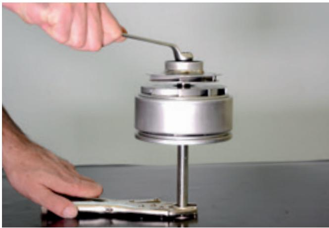
15. Trave o eixo e com o auxílio de uma chave combinada 17 mm, aperte o parafuso de fixação do kit hidráulico.
