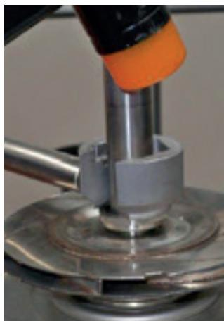
15. Vire o gabarito, posicione o mesmo sobre a porca e com o auxílio de um martelo de plastirene, solte o cone do rotor.
