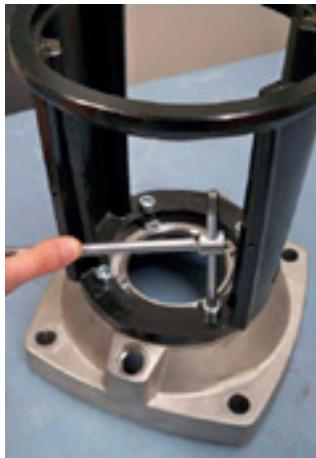
41. Com o auxílio de uma chave hexagonal 8 mm, aperte os parafusos de fixação do intermediário na tampa do intermediário. Torque de aperto: 40 Nm.
