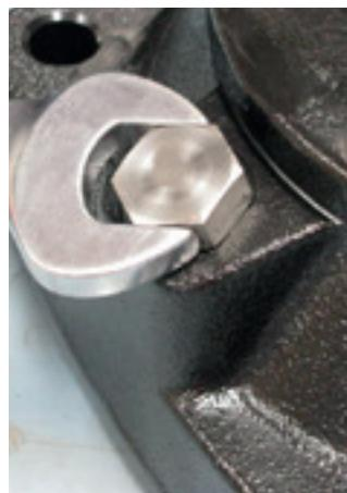
32. Com o auxílio de uma chave combinada 24 mm, coloque e aperte os bujões na tampa do intermediário. Torque de aperto: 40 Nm.
