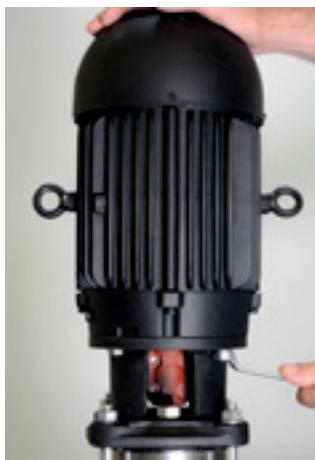
2. Com uma chave combinada 14 mm, solte e retire os parafusos de fixação do motor com o intermediário.
