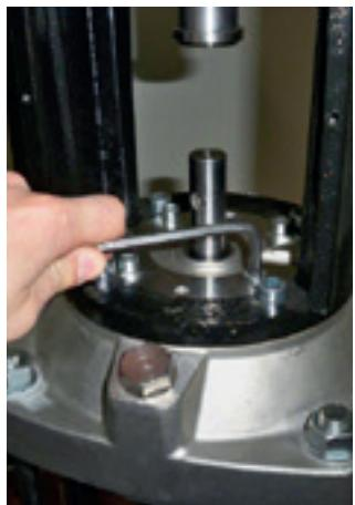
7. Com o auxílio de uma chave hexagonal 6 mm, solte os parafusos da tampa do selo mecânico.
