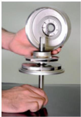
9. Coloque o difusor com o mancal. A posição do estágio mancal pode ser identificada no item 5. Repita o procedimento até completar o kit hidráulico.
