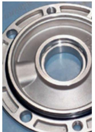
4. Coloque o anel o-ring na tampa do selo mecânico.
