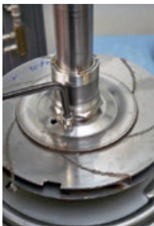
16. Com o auxílio de uma chave hexagonal 4 mm, coloque e aperte o parafuso de travamento da contraporca do rotor mancal. Recomenda-se a utilização de trava rosca de alto torque.
