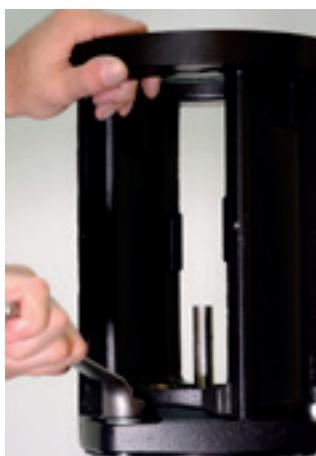
30. Com o auxilio de uma chave combinada 22 mm, aperte as porcas das hastes alternadamente em formato de "X".
