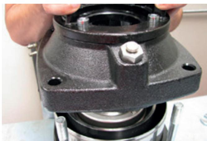
34. Lubrifique com álcool a parte interna da tampa do intermediário e posicione-a juntamente com o adaptador curto do motor, sobre o kit hidráulico.
