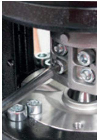
15. Com o auxílio de uma chave hexagonal 5 mm, aperte os parafusos do acoplamento de forma alternada em formato de "X".
