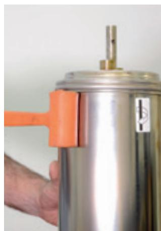
17. Com o auxílio de um martelo de plastiprene, bata levemente de baixo para cima na tampa do intermediário para retirá-la.
