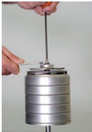
14. Com o auxílio de uma chave hexagonal 4 mm, trave o eixo e com uma chave combinada 13 mm, posicione e aperte a porca do eixo.
