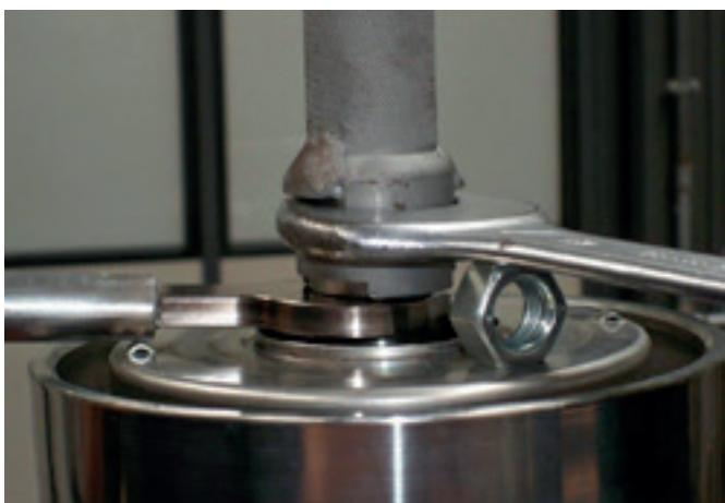
25. Coloque um calço de 40 mm sob a chave de boca 32 mm segurando o gabarito de posicionamento do selo mecânico. Levante o kit hidráulico e aperte a porca do assento do selo mecânico. Torque de aperto: 50 Nm.
