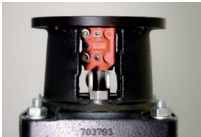
43. Posicione o gabarito de ajuste do acoplamento sob o acoplamento. A especificação dos gabaritos pode ser encontrada no item 15.
