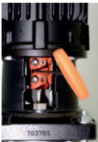
48. Com o auxílio de uma chave hexagonal 4 mm, solte o parafuso de abertura do acoplamento.
