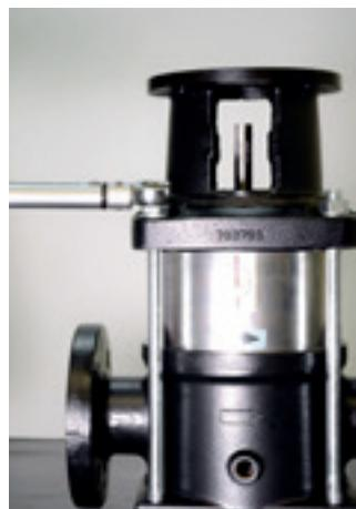
28. Com o auxílio de um torquímetro regulado em 50 Nm, aperte a porca das hastes alternadamente em formato de "X".
