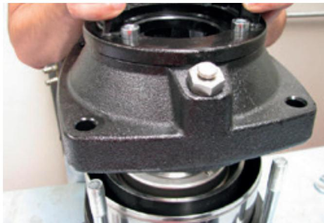
40. Lubrifique com álcool a parte interna da tampa do intermediário e posicione-a juntamente com o adaptador curto do motor, sobre o kit hidráulico.
