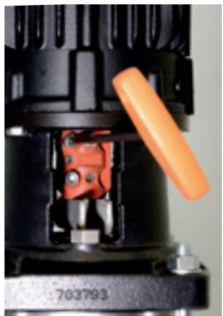
51. Com o auxílio de uma chave hexagonal 6 mm, aperte definitivamente os parafusos de fechamento do acoplamento.
