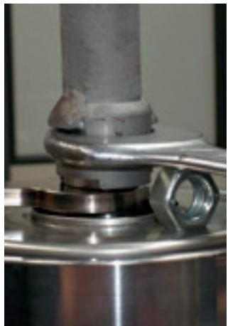
20. Coloque um calço de 40 mm sob a chave de boca 32 mm segurando o gabarito de posicionamento do selo mecânico. Levante o kit hidráulico e aperte a porca do assento do selo mecânico. Torque de aperto: 50 Nm.
