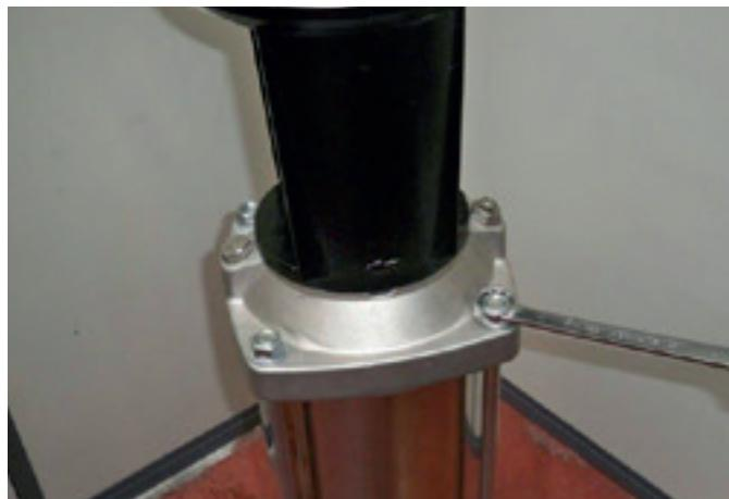
45. Posicione o intermediário juntamente com a tampa do intermediário sobre o kit hidráulico e com o auxílio de uma chave combinada 24 mm, aperte as porcas das hastes. Torque de aperto: 100 Nm.
