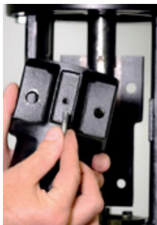
45. Posicione o parafuso central no acoplamento alinhando no canal de chaveta do eixo do motor.
