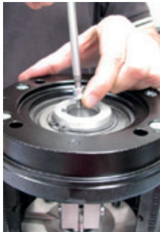
13. Coloque o parafuso e a arruela de fixação do eixo do bombeador.
