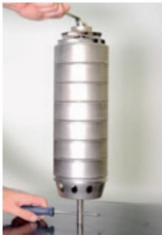
27. Trave o eixo do kit hidráulico e com uma chave combinada de 17 mm, solte e retire o parafuso e a arruela de fixação do eixo.
