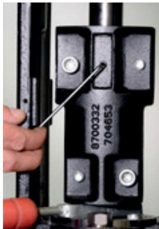
50. Com auxílio de uma chave hexagonal 3 mm, aperte o parafuso central para travar o eixo do motor no acoplamento.
