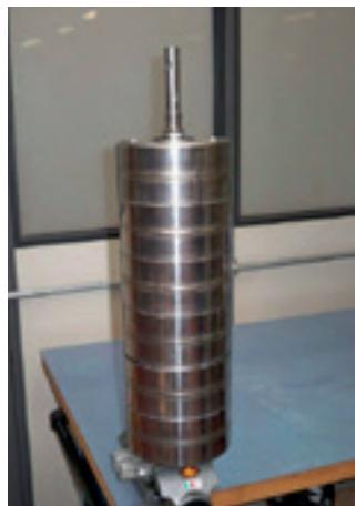
8. Prenda o kit hidráulico em uma morsa. Utilize protetor de dormentes para não danificar o eixo do bombeador.
