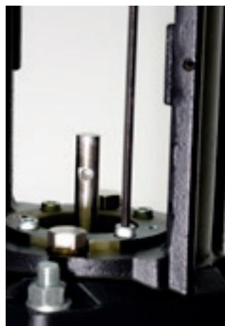
7. Com o auxílio de uma chave hexagonal 6 mm, solte os parafusos de fixação da tampa do selo mecânico.
