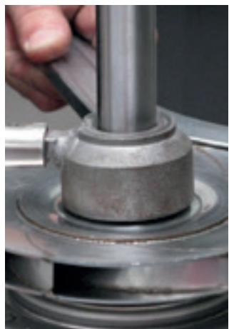
11. Fixe o rotor e com o auxílio de uma chave de gancho, aperte a porca do rotor com o gabarito para rotor. Torque de aperto: 100 Nm.
