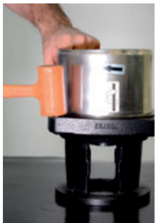
23. Com o auxílio de um martelo de plastiprene, retire o intermediário da carcaça do bombeador.
