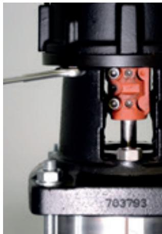
2. Com o auxílio de uma chave combinada 14 mm, solte e retire os parafusos de fixação do motor com o intermediário.
