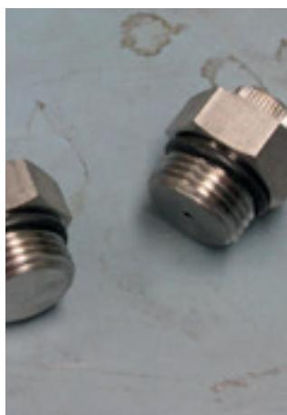
37. Coloque os o-rings nos bujões superiores e bujão superior com purgador.
