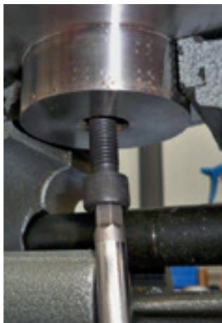
19. Com o auxilio de uma chave hexagonal 8 mm, solte o parafuso do gabarito base de montagem do eixo do bombeador.
