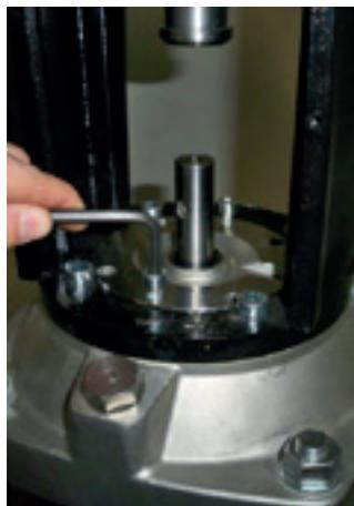
8. Utilize dois parafusos da tampa do selo como extratores para auxiliar a retirada da tampa do selo mecânico.
