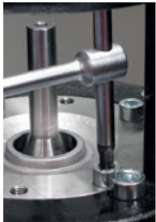
8. Com o auxilio de uma chave hexagonal 5 mm, retire os parafusos da tampa do selo mecânico.
