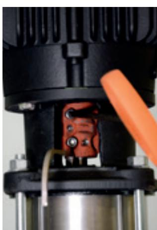
42. Com o auxílio de uma chave hexagonal 6 mm, aperte definitivamente os parafusos de fechamento do acoplamento.
