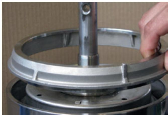
3. Retire a tampa de saída. Peça existente apenas para as séries VME-65 e VME-95.
