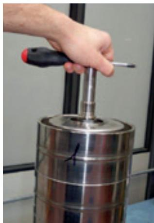
29. Retire o kit hidráulico do gabarito base de montagem.
