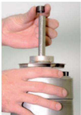
35. Retire a bucha mancal e o rotor. Repita o procedimento até desmontar todo o kit hidráulico.
