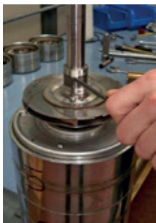
19. Com o auxílio de uma chave hexagonal 4 mm, solte e retire o parafuso de travamento da porca mancal.
