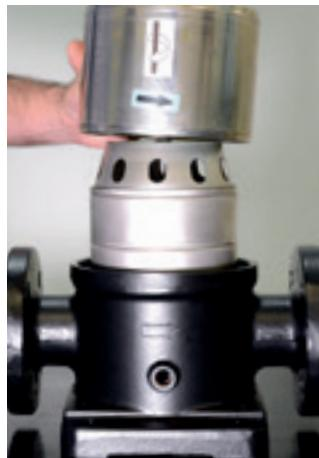
23. Coloque a carcaça do bombeador. Para facilitar a montagem utilize álcool.
