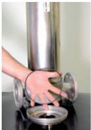
25. Coloque o o-ring na tampa do intermediário. Para facilitar o encaixe da tampa utilize álcool. Tampa presente nas versões inox.
