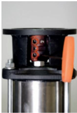
7. Com auxílio de uma chave hexagonal 4 mm, solte o parafuso de fixação do eixo do bombeador.
