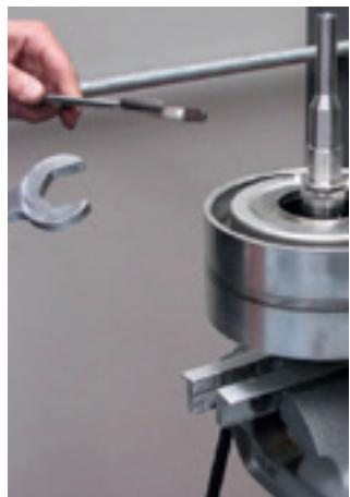
8. Vire o kit hidráulico, trave o eixo do bombeador e retire o kit de assento do selo mecânico.
