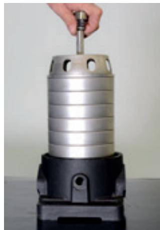
21. Coloque o selo mecânico. Para facilitar o posicionamento do selo utilize álcool.
