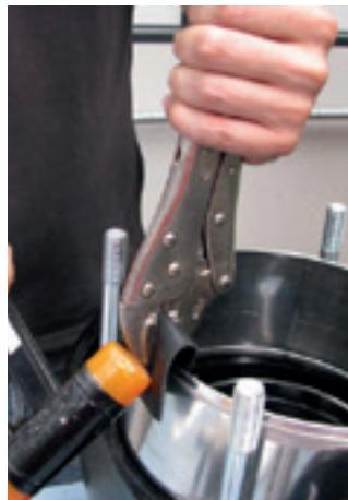
4. Para as bombas de 1 ou 2 estágios pode ser necessário o auxílio de um martelo de plastiprene e um alicate de pressão para retirada da carcaça do bombeador.
