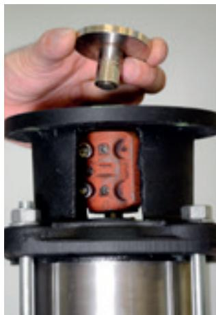
34. Solte o parafuso de fixação do eixo do motor e retire o gabarito de ajuste do eixo.
