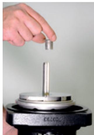
36. Retire o outro distanciador. Repita os demais passos até desmontar o kit hidráulico
