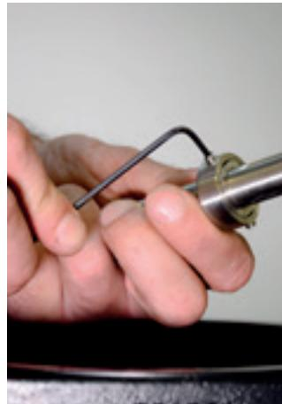
39. Com o auxilio de uma chave hexagonal 2,5 mm, abra e retire o assento do selo mecânico.
