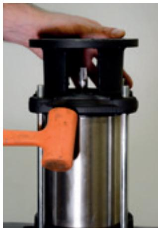
11. Com o auxílio de um martelo de plastiprene, batendo levemente de baixo para cima, libere da base da motobomba, a carcaça juntamente com o intermediário.
