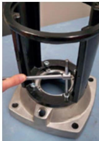
39. Com o auxílio de uma chave hexagonal 8 mm, aperte os parafusos de fixação do intermediário na tampa do intermediário. Torque de aperto: 40 Nm.
