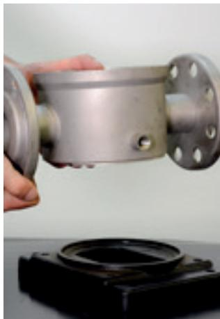
25. Retire a base com flange da base da motobomba. Para as motobombas em ferro fundido, a base com flange e a base da motobomba são um a peça única.
