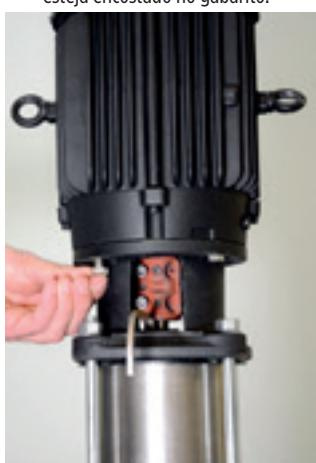
37. Coloque os parafusos de fixação do intermediário no motor.
