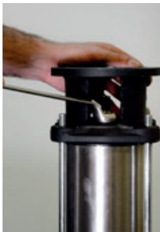
10. Com o auxílio de uma chave combinada 22 mm, solte e retire o bujão superior.
