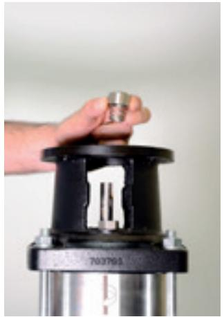
14. Retire o selo mecânico. Para facilitar a retirada do selo, utilize álcool para lubrificar o eixo.
