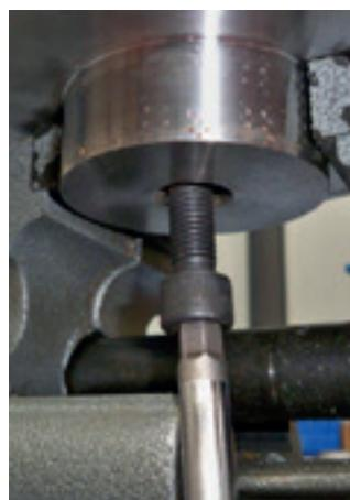
26. Com o auxílio de uma chave hexagonal 8 mm, solte o parafuso do gabinete base de montagem do eixo do bombeador.
