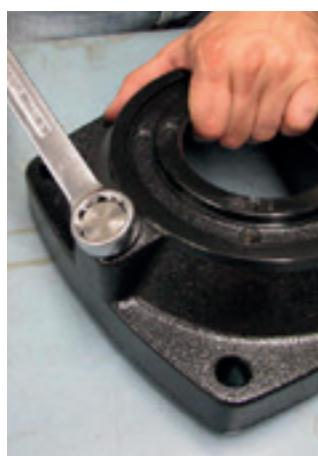
17. Com o auxílio de uma chave combinada 24 mm, retire o bujão superior.
