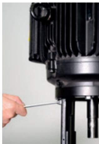
5. Com uma chave combinada 19 mm, solte os parafusos de fixação do motor no intermediário.
