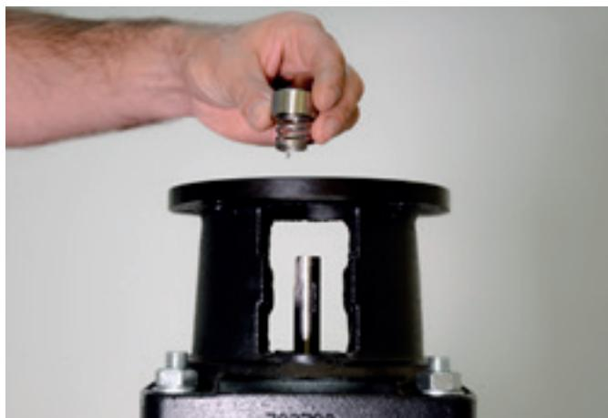
29. Posicione o selo mecânico de forma que o pino da mola encaixe no assento do selo mecânico. Para a facilitar a colocação do selo mecânico lubrifique o eixo com álcool.
