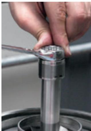
29. Vire o kit hidráulico, coloque a bucha mancal e o kit de fixação do eixo apertando o parafuso de fixação. Recomenda-se a utilização de trava rosca de alto torque. Torque de aperto: 50 Nm.
