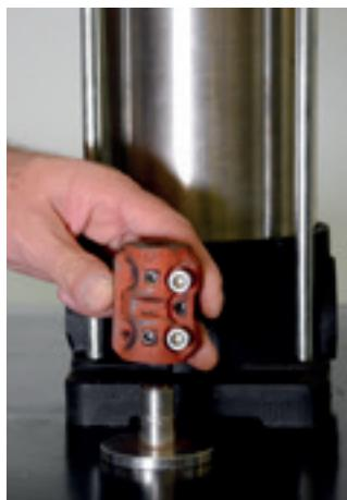
30. Posicione o acoplamento sobre o gabarito de ajuste do eixo e coloque todos os parafusos. A especificação dos gabaritos pode ser identificada no item 15.
