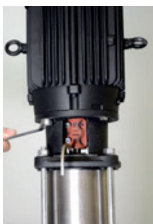
38. Com auxílio de uma chave combinada 14 mm, aperte os parafusos de fixação do intermediário no motor alternadamente em formato de "X".
