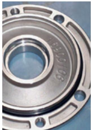
4. Coloque o anel o-ring na tampa do selo mecânico.
