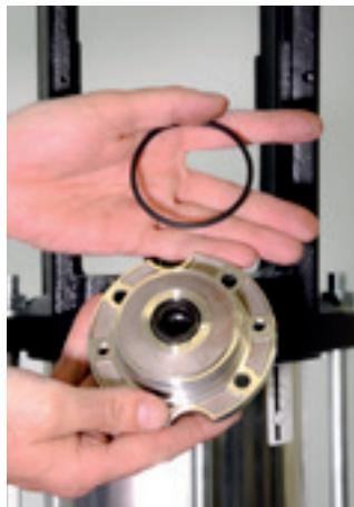
38. Coloque o o-ring da tampa do selo mecânico.
