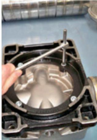
2. Com o auxílio de uma chave hexagonal 8 mm, aperte os parafusos de fixação da base da motobomba.
