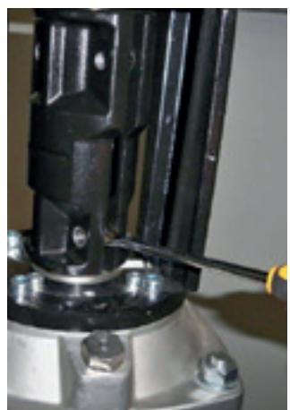
1. Com o auxílio de uma chave Philips, solte os parafusos da tampa protetora.
