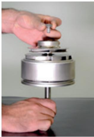
14. Posicione o parafuso de travamento do kit hidráulico. Recomenda-se o uso de trava rosca de alto torque.
