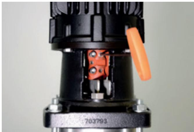
52. Com o auxílio de uma chave hexagonal 4 mm, aperte definitivamente os parafusos de fixação do eixo do motor e do eixo do bombeador e dê um leve aperto no parafuso de abertura do acoplamento.
