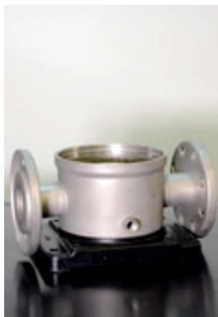
17. Coloque a base com flange sobre a base da motobomba.
