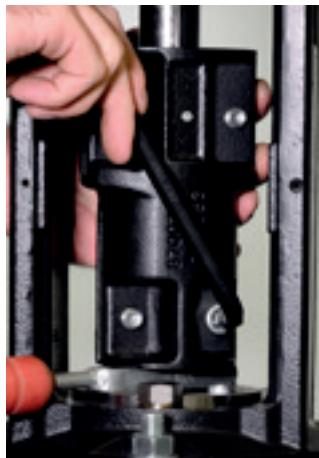
49. Com o auxílio de uma chave hexagonal 10 mm, aperte os parafusos de fechamento do acoplamento alternadamente.
