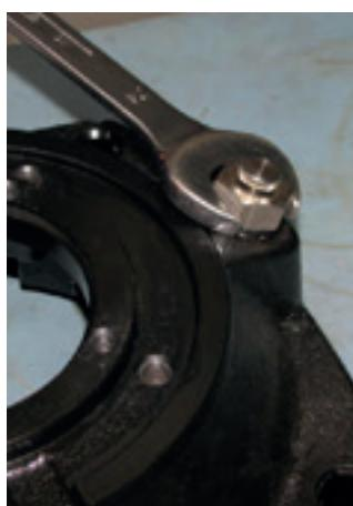
18. Com o auxílio de uma chave combinada 24 mm, retire o bujão superior com purgador.
