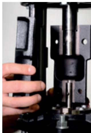
4. Retire o acoplamento bipartido juntamente com o pino do eixo.
