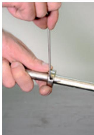
38. Com auxílio de uma chave hexagonal 2,5 mm, abra o assento do selo mecânico.
