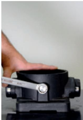
18. Com o auxílio de uma chave combinada 19 mm, solte e retire o bujão inferior.
