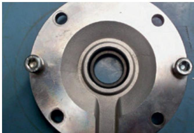
9. Detalhe da posição dos parafusos extratores.
