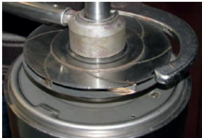
20. Fixe o rotor e com o auxílio de uma chave de gancho, aperte a porca do rotor com o gabinete para rotor. Torque de aperto: 100 Nm.
