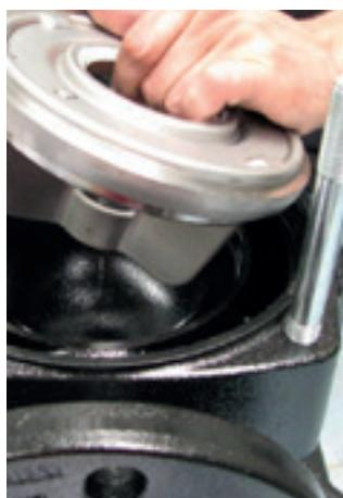
24. Coloque o kit tampa de entrada na base com flange, com as hastes já posicionadas.
