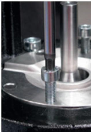
9. Utilize dois parafusos da tampa do selo como extratores para auxiliar a retirada da tampa do selo mecânico.
