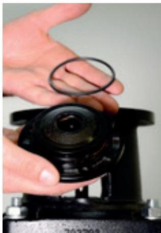
31. Coloque o anel o-ring da tampa do selo mecânico.
