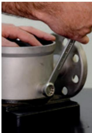
23. Retire o bujão inferior com o auxílio de uma chave combinada 19 mm.
