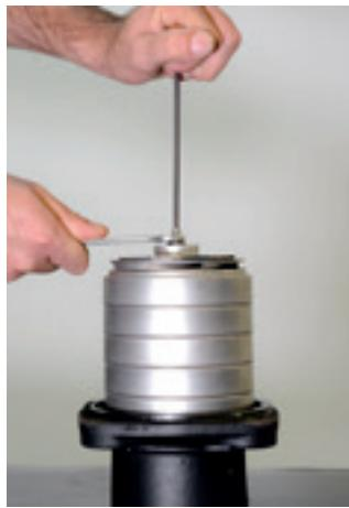
28. Com o auxílio de chave hexagonal 4 mm, trave o eixo e com uma chave combinada 13 mm, retire a porca do eixo.
