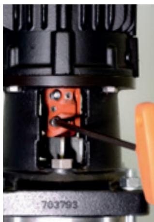
49. Com o auxílio de uma chave hexagonal 6 mm, aperte os parafusos de fechamento do acoplamento.
