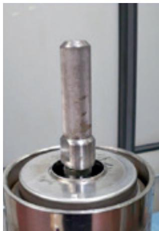
23. Coloque o gabarito de posicionamento do selo mecânico no assento do selo mecânico.
