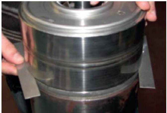
16. Coloque as réguas de 1 mm de espessura entre os difusores.
