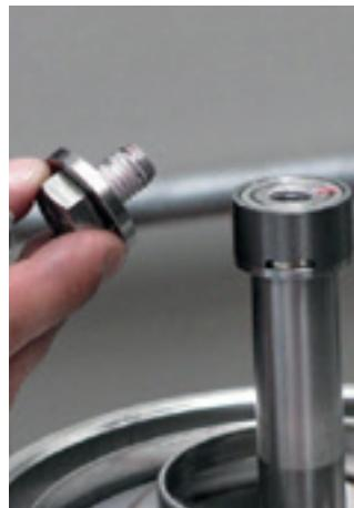
7. Trave o eixo e com o auxílio de uma chave combinada 17 mm, solte o parafuso e a arruela de fixação do eixo e retire a bucha mancal e o alojamento.
