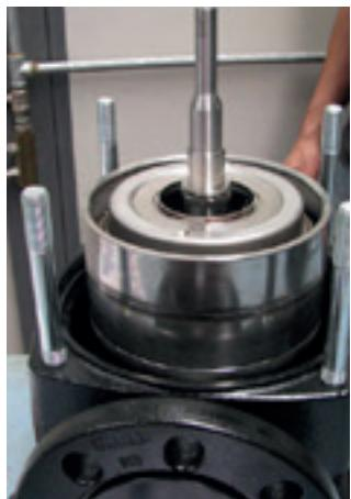
27. Coloque o kit hidráulico na base com flange.
