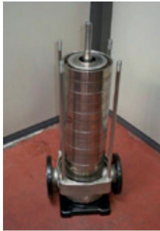
36. Coloque o kit hidráulico na base com flange
