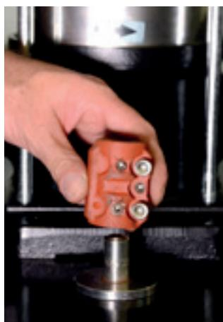
39. Posicione o acoplamento no gabarito de ajuste do eixo com todos os parafusos já posicionados.
