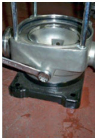
1. Com o auxilio de um martelo de plastiprene, retire o flange deslocando-o para trás.
