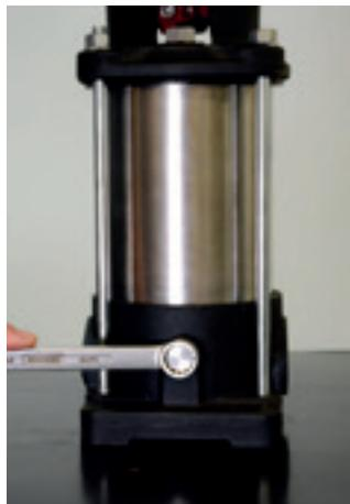
50. Com o auxílio de uma chave combinada 22 mm, aperte o bujão inferior.
