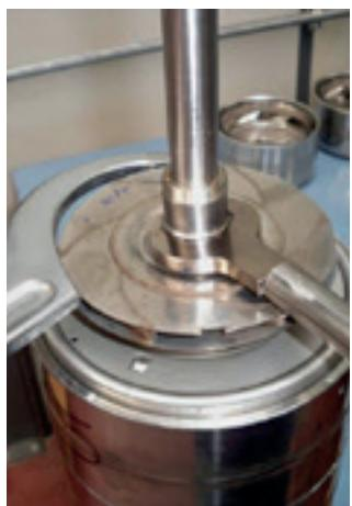
15. Fixe o rotor e com o auxílio de uma chave de gancho e aperte a porca do rotor com o gabarito para rotor. Torque de aperto: 100 Nm.
