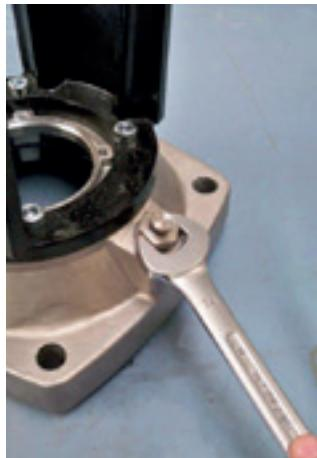
43. Com o auxílio de uma chave combinada 24 mm, coloque e aperte os bujões superiores na tampa do intermediário. Torque de aperto: 40 Nm.
