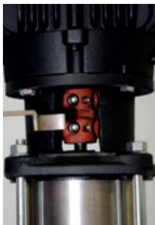
45. Retire o gabarito de ajuste do acoplamento.
