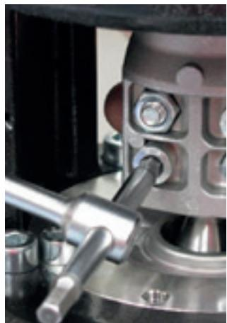
5. Com o auxilio de uma chave hexagonal 5 mm, solte os parafusos do acoplamento.
