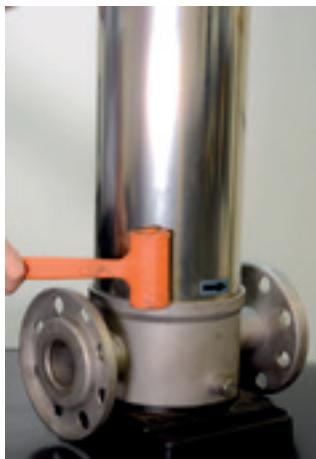
21. Com auxílio de um martelo de plastiprene bata levemente de cima para baixo e retire a carcaça do bombeador.
