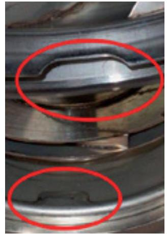
11. Detalhe da montagem correta do difusor, observando as partes com chanfro.
