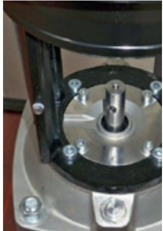
10. Com o auxílio de uma chave hexagonal 6 mm, aperte os parafusos de fixação da tampa do selo mecânico alternadamente em formato de "X". Torque de aperto: 20 Nm.
