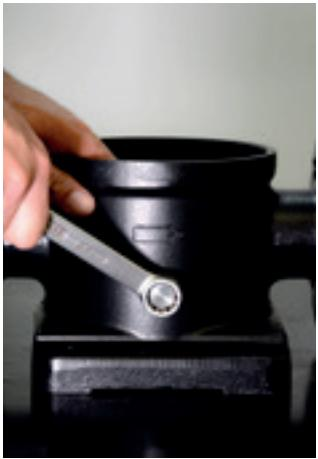
21. Com o auxílio de uma chave combinada 19 mm, retire o bujão inferior.
