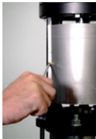
2. Com o auxílio de uma chave Philips, retire as duas tampas protetoras do acoplamento.
