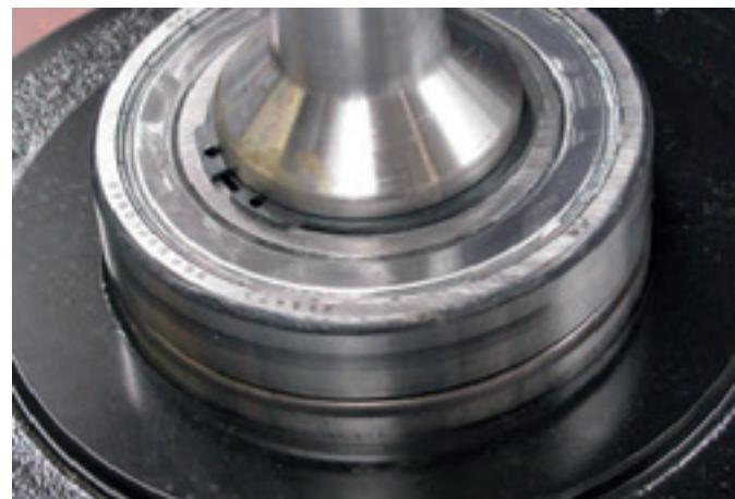
8. Insira o semi eixo com os rolamentos no adaptador do motor.
