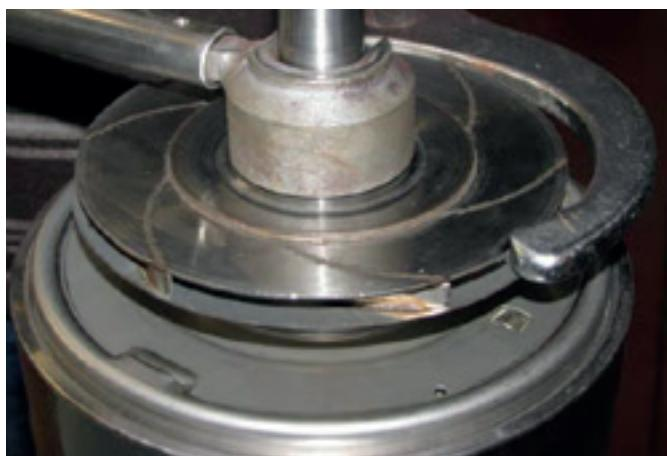
19. Fixe o rotor e com o auxílio de uma chave de gancho, aperte a porca do rotor com o gabarito para rotor. Torque de aperto: 100 Nm.
