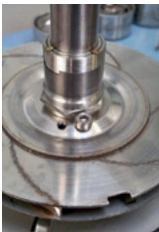
17. Observe que existem dois furos no rotor para realizar o travamento do conjunto. O furo a ser utilizado depende da posição do rotor.
