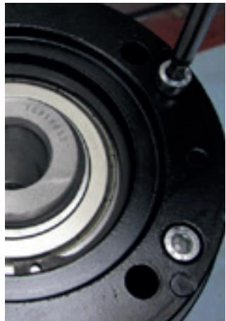
12. Com o auxílio de uma chave hexagonal 6 mm, aperte os parafusos do adaptador curto do motor alternadamente em formato de "X". Torque de aperto: 16 Nm.
