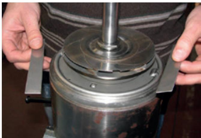
10. Retire as duas réguas de 1 mm de espessura.
