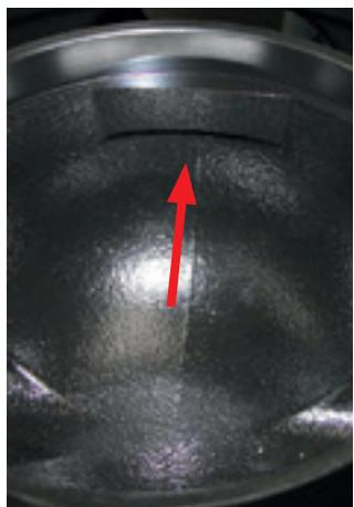
32. Observe a saliência existente na base com flange para o perfeito encaixe da tampa de entrada.
