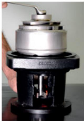
27. Trave o eixo e com o auxilio de uma chave combinada 17 mm, solte e retire o parafuso e arruela de fixação do kit hidráulico.
