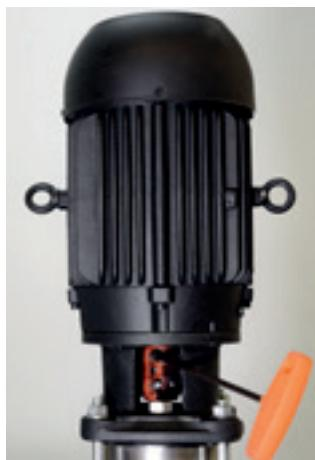
3. Com o auxílio de uma chave hexagonal 6 mm, solte os parafusos (inferior e superior) de fechamento do acoplamento.
