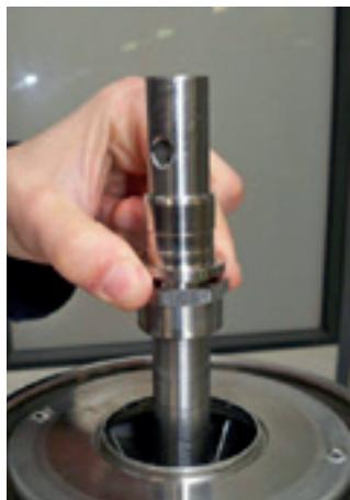
10. Retire o kit assento do selo mecânico. Para facilitar a retirada utilize álcool no eixo do bombeador.
