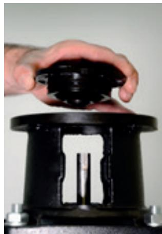
33. Coloque a tampa do selo mecânico. Utilize álcool para facilitar o processo.
