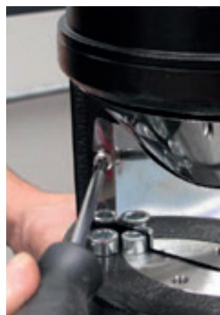
1. Com o auxílio de uma chave Philips, solte os parafusos da tampa protetora do acoplamento.
