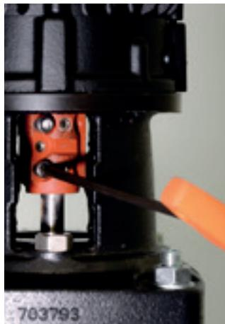
3. Com o auxílio de uma chave hexagonal 6 mm, solte os parafusos de fechamento do acoplamento.
