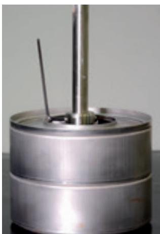
18. Com o auxílio de uma chave hexagonal 2,5 mm, aperte o parafuso do assento do selo mecânico.
