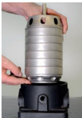
19. Posicione o kit hidráulico sobre a base da motobomba.
