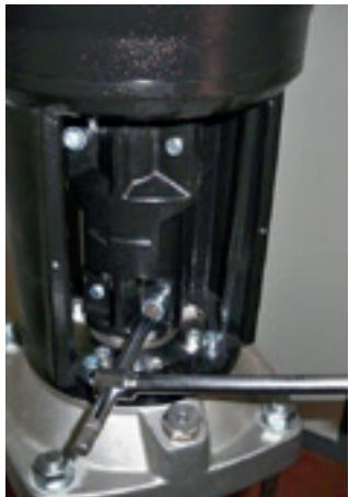
15. Com o auxílio de uma chave hexagonal 10 mm, aperte os parafusos do acoplamento alternadamente em formato de X. Torque de aperto: 50 Nm.
