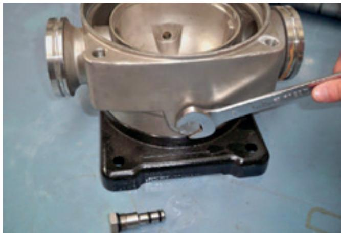
4. Posicione os bujões na base com flange e aperte-os com o auxílio de uma chave combinada 24 mm. Torque de aperto: 40 Nm.
