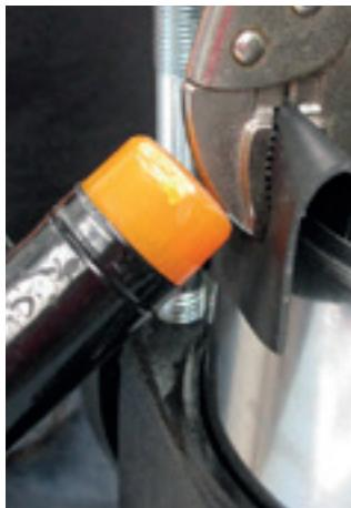
5. Utilize uma proteção adequada para evitar danos à carcaça do bombeador.
