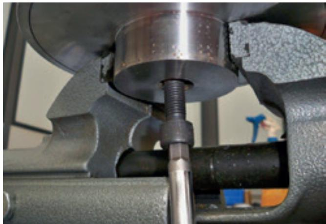
26. Com o auxílio de uma chave hexagonal 10 mm, solte o parafuso do eixo do gabarito base de montagem.
