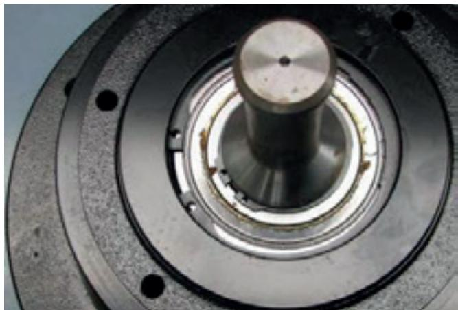
3. Detalhe dos dois anéis elásticos no adaptador do motor.
