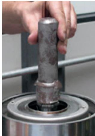
23. Coloque o gabinete de posicionamento do selo mecânico sobre o assento do selo mecânico.
