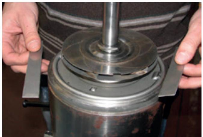
10. Retire as duas réguas de 1 mm de espessura.
