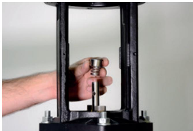
35. Coloque o selo mecânico de forma que o pino da mola encaixe no assento do selo mecânico. Para facilitar a colocação do selo mecânico, lubrifique o eixo com álcool.
