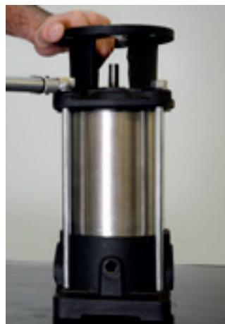
29. Com o auxílio de torquímetro regulado em 50 Nm, aperte a porca das hastes alternadamente em formato de "X".
