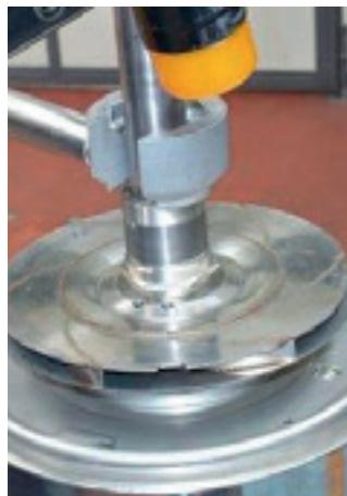
22. Continue a operação até desmontar todo o kit hidráulico.
