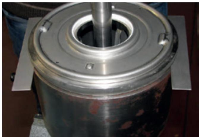
7. Coloque duas réguas de 1 mm cada entre a base do gabarito de montagem e a base do kit da tampa de entrada.
