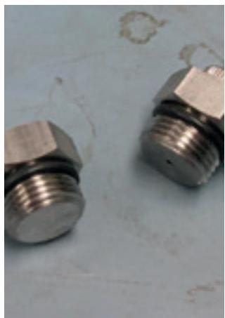
31. Coloque o anel o-ring nos bujões e lubrifique-os com álcool.
