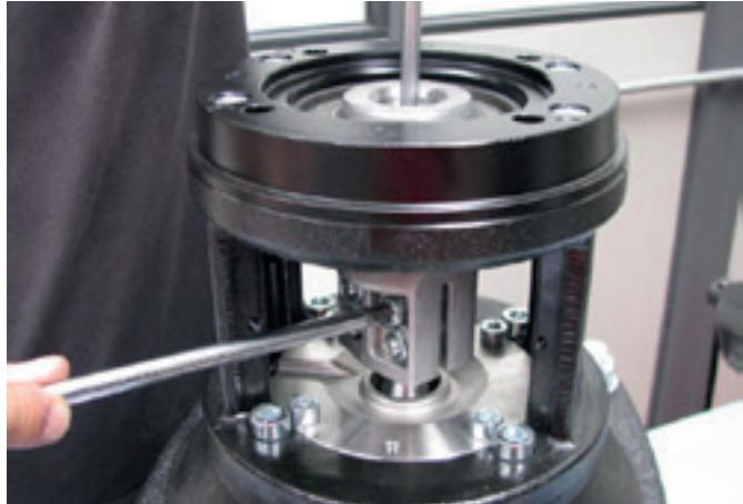
16. Trave o eixo do bombeador e com o auxilio de uma chave hexagonal 5 mm, aperte o parafuso de fixação do eixo do bombeador.
