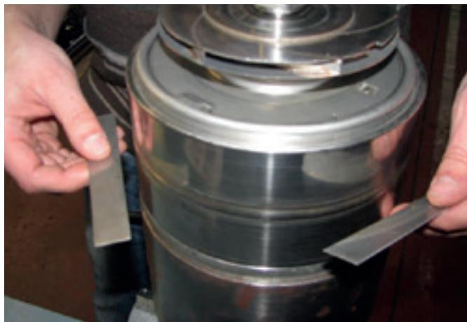
19. Retire as réguas de 1 mm de espessura.
