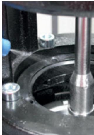
1. Lubrifique o eixo do bombeador com álcool para facilitar a colocação do selo mecânico.
