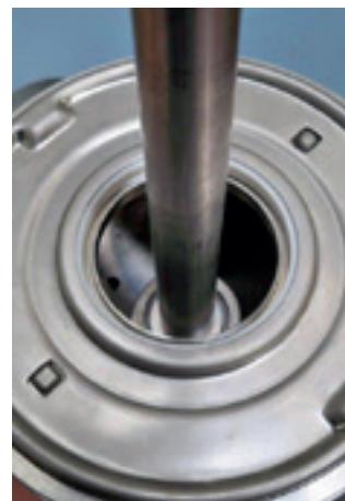
5. Coloque o eixo do bombeador.
