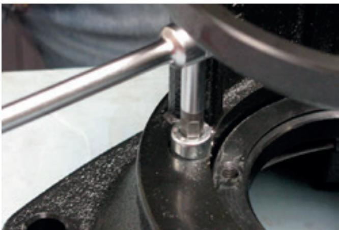
33. Posicione o adaptador curto do motor sobre a tampa do intermediário e com o auxílio de uma chave hexagonal 8 mm, aperte os parafusos de fixação.
