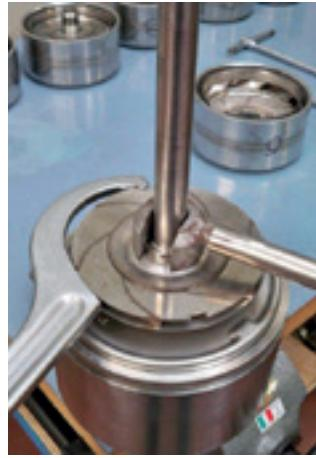
9. Fixe o rotor e com o auxílio de uma chave de gancho, aperte a porca do rotor com o gabarito para rotor. Torque de aperto: 100 Nm.
