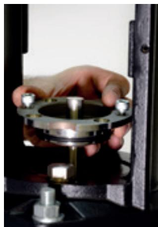
9. Aperte os parafusos extractores e retire a tampa do selo mecânico.
