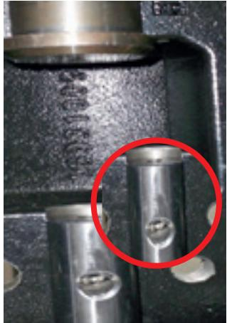
11. Posicione uma das partes do acoplamento bipartido no semi eixo do adaptador do motor para verificar o desalinhamento dos furos do acoplamento e do eixo do bombeador.
