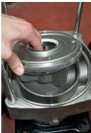
33. Coloque o kit tampa de entrada na base com flange, com as hastes já posicionadas.
