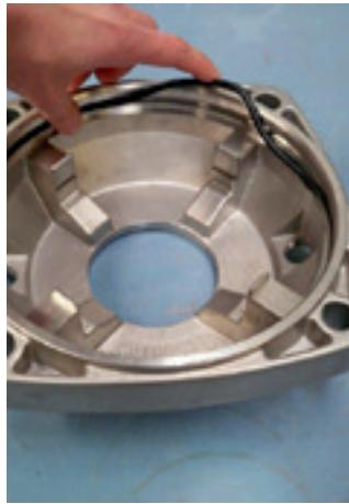
38. Coloque o anel o-ring na base da motobomba.
