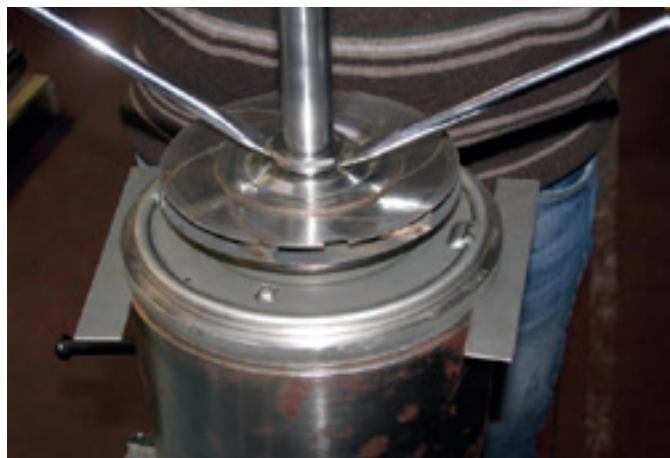
9. Com o auxílio de duas chaves de fenda, levante a contraporca do rotor. Atenção ao correto posicionamento da chave para não danificar o rotor nessa operação.
