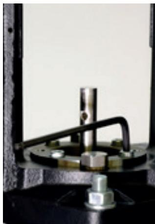
41. Com o auxílio de uma chave hexagonal 6 mm, aperte os parafusos de fixação da tampa do selo mecânico alternadamente em formato de “X”.
