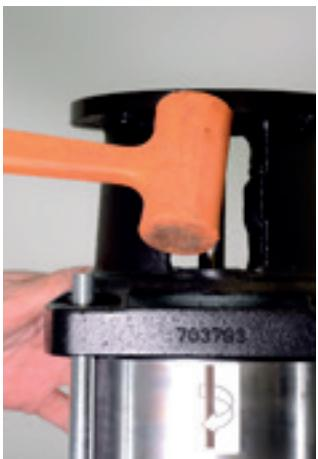
17. Com o auxílio de um martelo de plastiprene, retire o intermediário juntamente com a carcaça do bombeador batendo levemente de baixo para cima.
