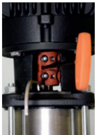
44. Com o auxílio de uma chave hexagonal 4 mm, dê um leve aperto no parafuso de abertura do acoplamento para que o mesmo não solte com a vibração.
