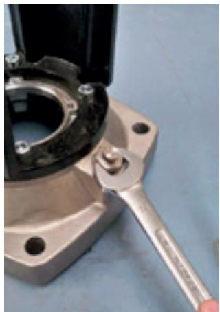
41. Com o auxílio de uma chave combinada 24 mm, coloque e aperte os bujões superiores na tampa do intermediário. Torque de aperto: 40 Nm.
