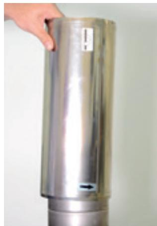
24. Coloque a carcaça. Utilize álcool para facilitar o encaixe.
