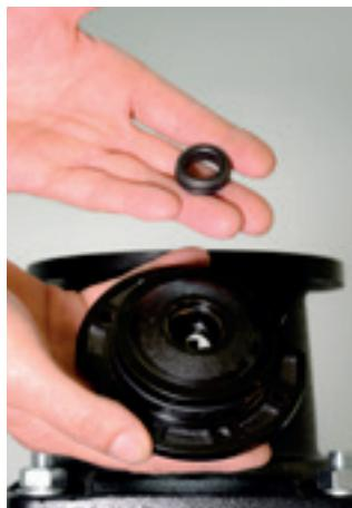
32. Encaixe a sede do selo mecânico na tampa do selo. Para facilitar o encaixe da peça, lubrifique o alojamento com álcool.
