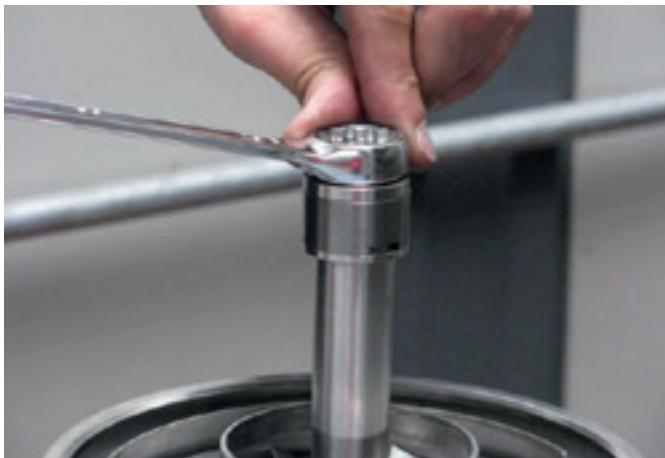
22. Vire o kit hidráulico, coloque a bucha mancal e o kit de fixação do eixo apertando o parafuso de fixação. Recomenda-se a utilização de trava rosca de alto torque. Torque de aperto: 50 Nm.
