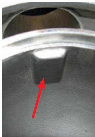
34. Observe a saliência existente na base com flange para o perfeito encaixe da tampa de entrada.
