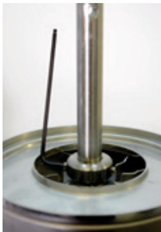
22. Com o auxilio de uma chave hexagonal 2,5 mm, aperte os parafusos do assento do selo mecânico.
