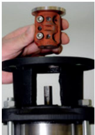
32. Posicione o acoplamento no eixo do bombeador, alinhando o canal de chaveta com o parafuso de fixação do eixo do motor.
