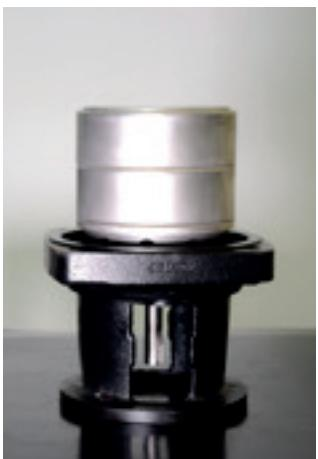
25. Utilize um suporte como apoio para desmontar o kit hidráulico.
