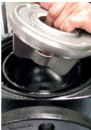
31. Coloque o kit tampa de entrada com a base com flange.
