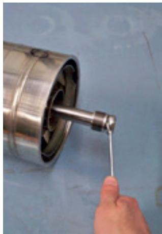
6. Trave o eixo e com o auxílio de uma chave combinada 19 mm, retire o parafuso e a arruela de fixação do eixo do bombeador.
