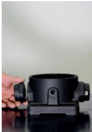
19. Com o auxílio de uma chave hexagonal 8 mm, retire os parafusos de fixação e os flanges.
