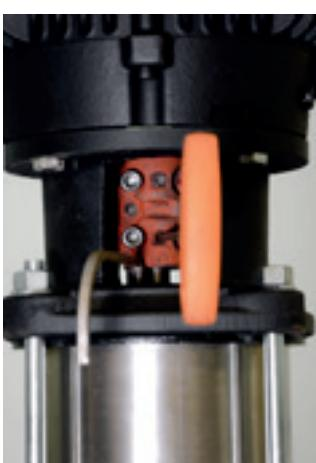
41. Com auxílio de uma chave hexagonal 4 mm, solte os parafusos de fixação do eixo do bombeador e do eixo do motor.
