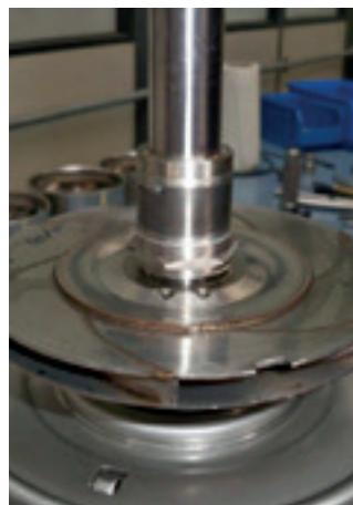
21. Coloque a porca do rotor mancal na mesma altura do cone do rotor.
