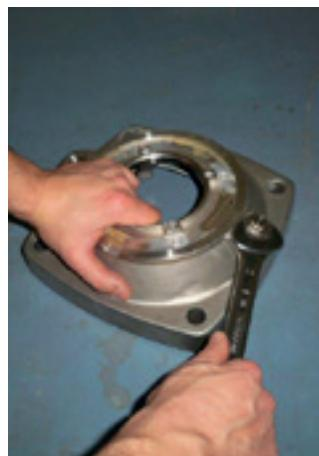
25. Com o auxílio de uma chave combinada 24 mm, solte e retire os bujões superiores.
