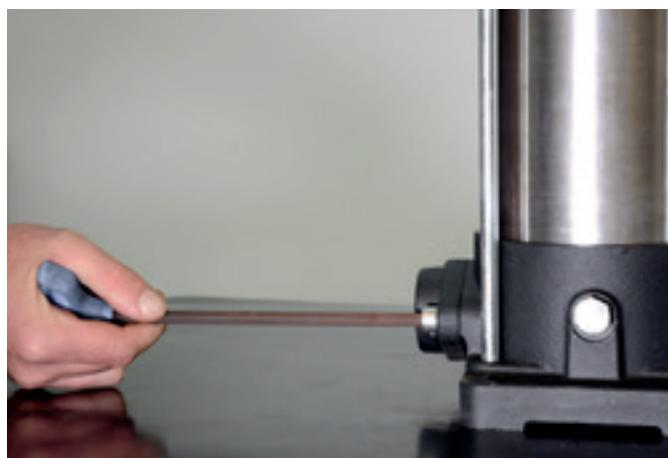
52. Para finalizar a montagem, com o auxílio de uma chave hexagonal 8 mm, posicione e aperte o parafuso de fixação dos flanges.
