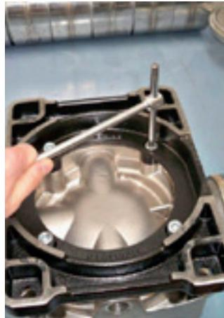
2. Com o auxílio de uma chave hexagonal 8 mm, aperte os parafusos de fixação da base da motobomba. Torque de aperto: 40 Nm.
