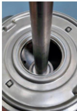
5. Coloque o eixo do bombeador.
