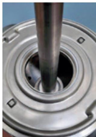
5. Coloque o eixo do bombeador.
