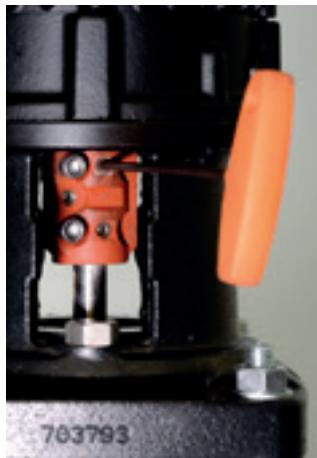
4. Com o auxílio de uma chave hexagonal 4 mm, solte o parafuso de fixação do eixo do motor.
