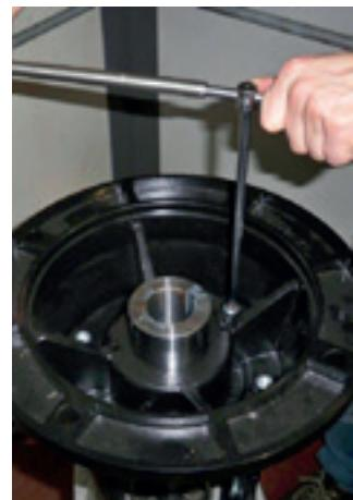
11. Com o auxílio de um chave hexagonal 8 mm, coloque e aperte os parafusos de fixação do adaptador do motor alternadamente em formato de "X".
