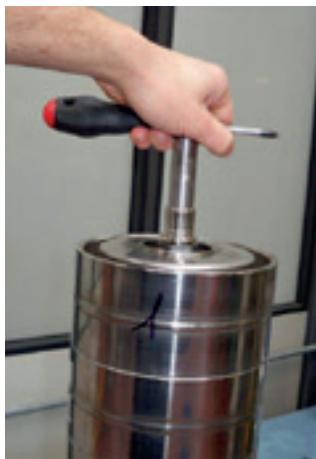
27. Retire o kit hidráulico do gabarito base de montagem.
