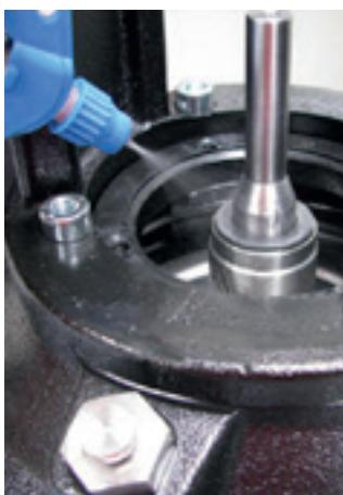
13. Lubrifique o eixo do bombeador com álcool para facilitar a retirada do selo mecânico.
