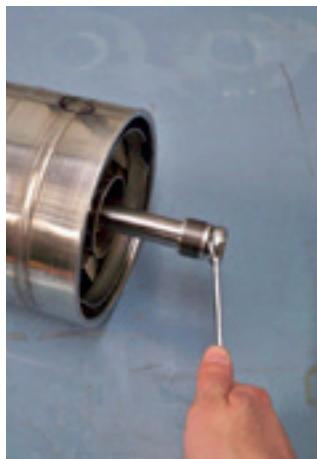
29. Coloque o parafuso e a arruela do kit de fixação do eixo e com o auxílio de uma chave combinada 19 mm, aperte o parafuso. Torque de aperto: 50 Nm.
