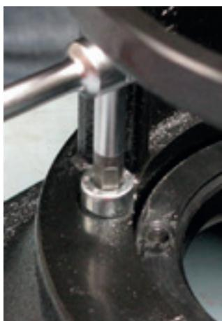
39. Posicione o adaptador curto do motor sobre a tampa do intermediário e com o auxílio de uma chave hexagonal 8 mm, aperte os parafusos de fixação.
