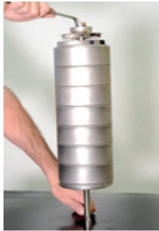
15. Trave o eixo e com uma chave combinada 17 mm, aperte o parafuso de fixação do eixo do kit hidráulico.
