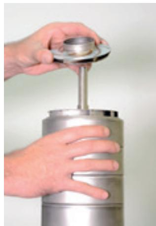
10. Coloque o rotor. Repita o procedimento até o rotor do primeiro estágio.
