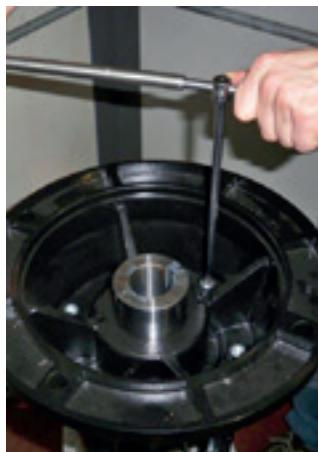
1. Com o auxílio de uma chave hexagonal 8 mm, solte e retire os parafusos de fixação do adaptador do motor.
