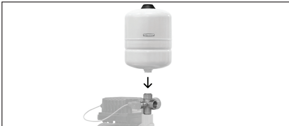
Figura 2 - Instalação do tanque de pressão
