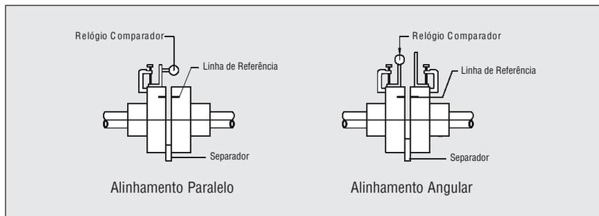
**Figura 28** - Alinhamento do acoplamento usando relógio comparador.
