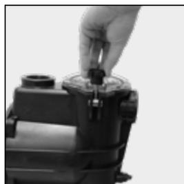
G. Aperte o parafuso de fixação na parte superior do pré-filtro.
