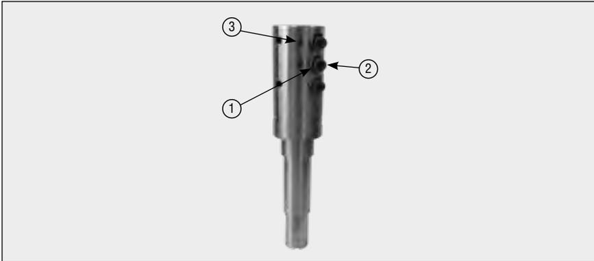
**Figura 26** - Parafusos do acoplamento
