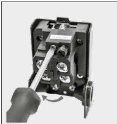
**Figura 16** - Regulagem das pressões de fechamento e abertura
