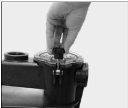
A. Solte os parafusos de fixação da tampa do pré-filtro sem retirá-los completamente.
