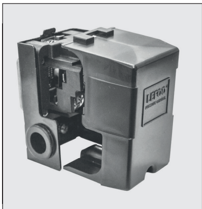
Figura 14 - Remoção da tampa do pressostato
