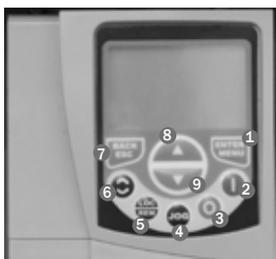
Figura 8A - Display inicial do inversor de frequência
