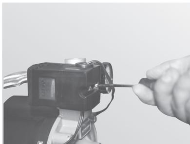
Figura 6 - Retirando tampa do pressostato 16-33
